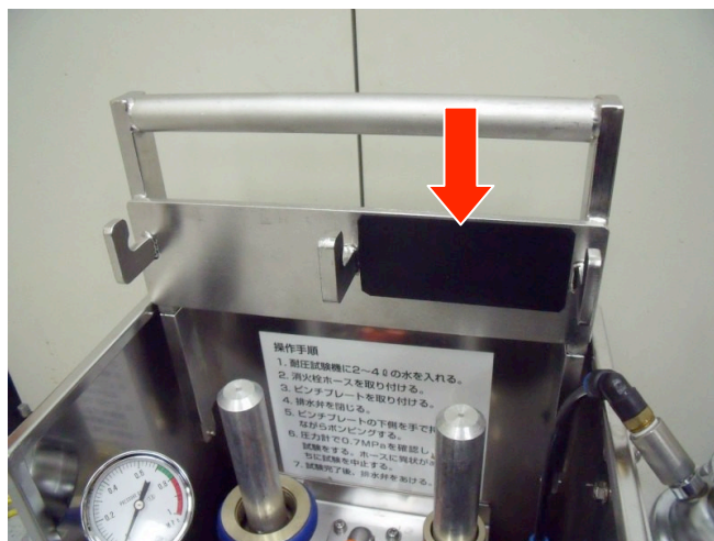
Photo 9 (右側のみゴムシートを取付けた状態)
