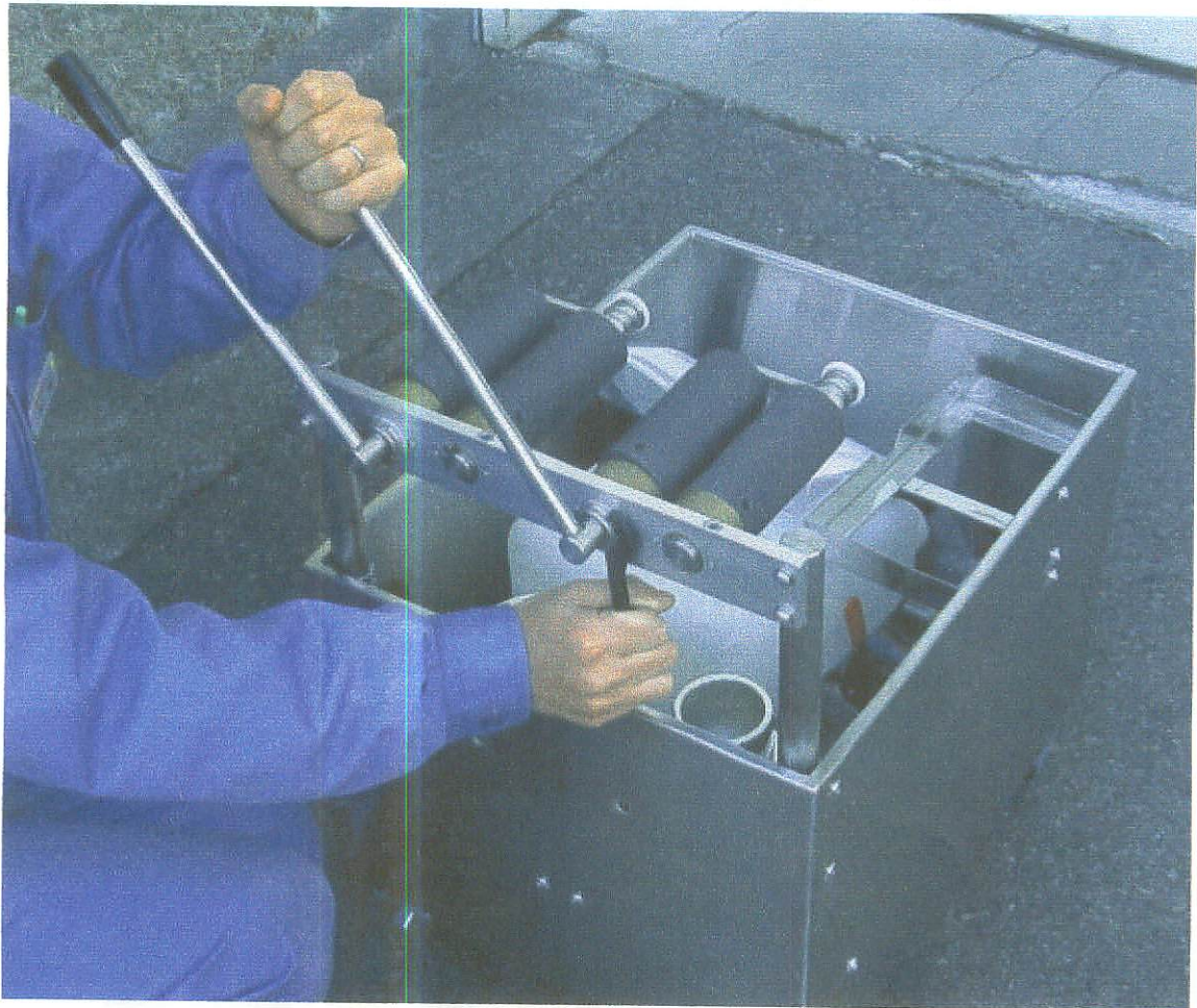
ハンドルを押さえ、工具をクランプブレーキの切り欠きに引掛けます。
